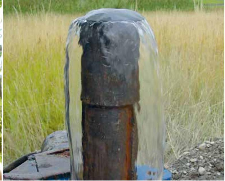
Bohrung mit artesischem Wasserauslauf
