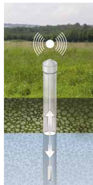
Digitaler Grundwasser-Messpegel mit Datenfernübertragung
