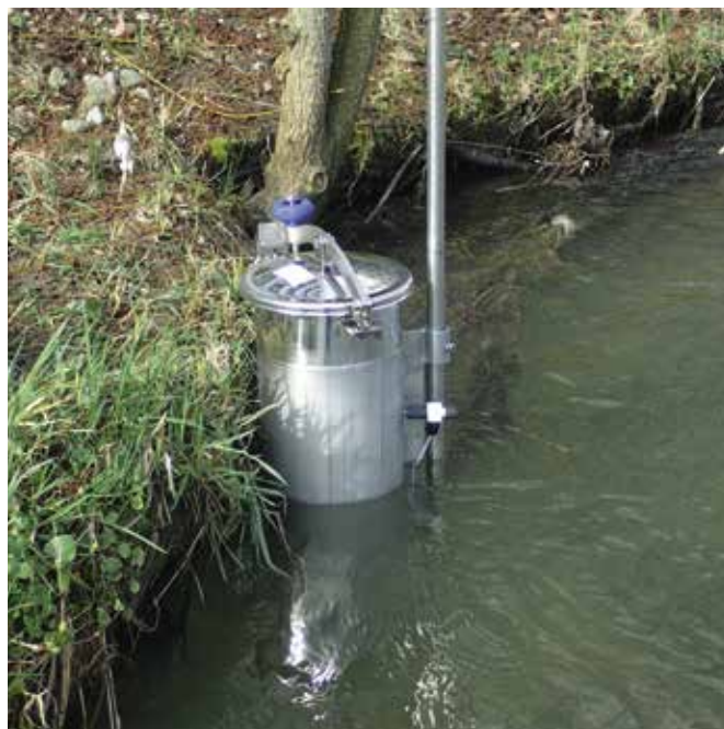
Sampler zur Entnahme von zeitproportionalen Mischproben aus kleinen Fließgewässern
