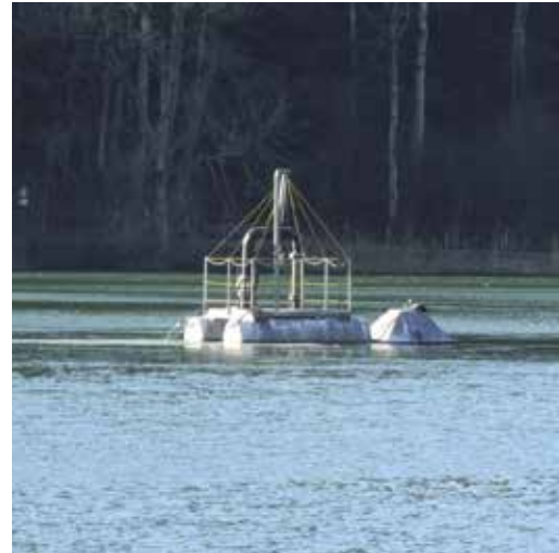
Anlage zur Unterstützung der Zirkulation im Türlerseer. Seit 2020 versuchsweise nicht mehr in Betrieb.
