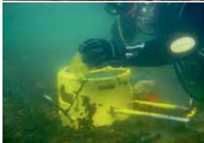
Probenahme der Wasserwirbellosen mittels Kicknetz im wathbaren Bereich (oben) und Surber Sampler mittels Taucher in der Flussmitte (unten).
