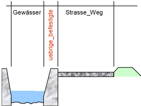
Die Mauerflächen zwischen Gewässern und einer direkt anschliessenden Strasse. Diese werden als 'uebrige\_befestigte.andere\_befestigte' Flächen definiert, da die Mauerfläche weder beim Gewässer noch bei der Strasse definiert wird. Regelung gilt für BB-Objekte der Art 'Strasse\_Weg', 'Trottoir' und 'Bahn'.
