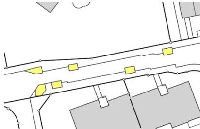
Auch einzelne bepflanzte Flächen, die den Fußgänger- und den Fahrzeugverkehr trennen, sind als 'uebrige\_humusierte.Verkehrsteilerflaeche' zu erheben.
