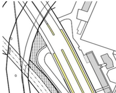
Vorwiegend humusierte Flächen, welche Verkehrsflächen für den Fußgänger- und/oder den Fahrzeugverkehr trennen, sind als 'uebrige\_humusierte.Verkehrsteilerflaeche' zu erheben.
