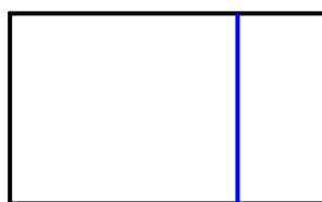
Gebäude werden unterteilt, wenn der Baukubus markante **mehrstöckige** Abstufungen aufweist. Markante, das Erscheinungsbild eines Gebäudekomplexes prägende Linien sind zu erfassen (Linienattribut 'Gebäudeunterteilung').
