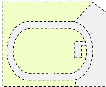
Um eine Abgrenzung zwischen wichtigen charakteristischen Merkmalen einer Sportanlage zu erhalten, werden z.B. die Laufbahn und die restlichen 'uebrige\_befestigte\_Sportanlage' in separaten Objekten definiert. Das heisst, dass zwei Objekte mit derselben BB-Art nebeneinander zu liegen kommen (Linienattribut 'harter\_Uebergang' erfassen). Die angrenzende befestigte Fläche (rechts) wird als 'uebrige\_befestigte\_Hausumschwung' erfasst.
