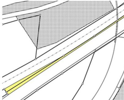
Der Trennstreifen zwischen Strassen/Weg und Bahn wird als 'uebrige\_humusierte.Verkehrsteilerflaeche' erhoben.
