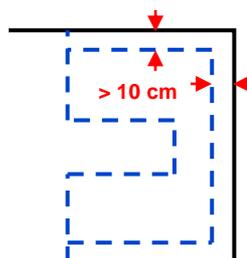
Die innere kleinste vertikale Fläche muss min. 10 cm gegenüber dem Fassadenanzug aufweisen und ist als EO 'uebriger\_Gebaeudeteil.uebriger\_Gebaeudeteil' zu erheben.
