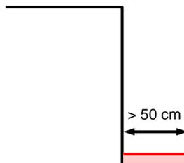
Eckmauern und an Fassaden anschließende Mauern werden grundsätzlich mit einer Tiefe > 50 cm nicht zum Gebäude definiert sondern als EO Mauern erhoben.
