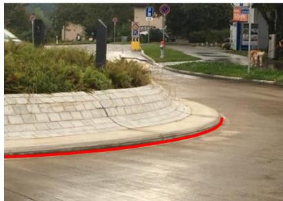
Links: Bei Kreiseln wird der befahrbare Teil („Pavé“) zur Strasse geschlagen und gehört nicht zur Verkehrsteilerfläche.
