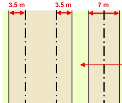
Als BB-Art 'Bahn' ist die gesamte Fläche bis zum Übergang in andere Bodenbedeckungsarten zu erheben. Die Zwischenfläche links im Bild ist der BB-Art 'uebrige\_humusierte\_Verkehrsteilerflaeche' zuzuweisen.
