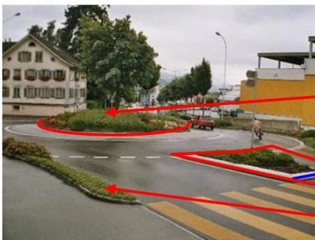
Die Strasse beinhaltet auch die Fläche des "Pavé" (Fläche, welche durch Gelenkbusse oder Sattelschlepper teilweise befahren werden).
