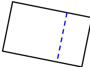
Im Zweifelsfalle sind die Umrisslinie in der Bodenbedeckung als Gebäude zu erheben. Die hinten liegende Linie wird als EO 'uebriger\_Gebaeudeteil' gezeichnet, wenn die Fassadenversetzung  $> 50 \text{ cm}$  in der TS2/TS3 und  $> 100 \text{ cm}$  in der TS4/TS5 ist.
