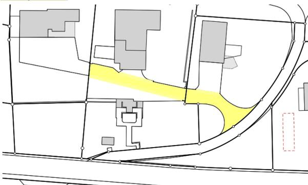
Obwohl keine bauliche Abgrenzung vorhanden ist, wird die Erschliessung der hinter liegenden Liegenschaften mit der Bestimmung sinnvoller fiktiver Linien erhoben. Bodenbedeckungslinien werden in diesen Fällen unterdrückt (Linienattribut). Zugänge zu den einzelnen Gebäudeeingängen sind wegzulassen.
