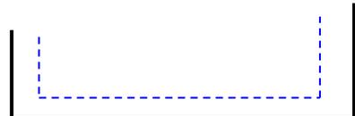
Zurückversetzte Sockelgeschosse werden als EO 'uebriger\_Gebaeudeteil.uebriger\_Gebaeudeteil' erhoben, wenn die Fassadenversetzung > 50 cm in der TS2/3 und > 100 cm in der TS4/5 ist.
