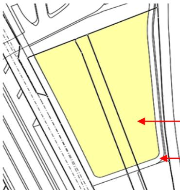
Bikeparks werden generalisiert erhoben. Die einzelnen Trails oder Installationen werden nicht erhoben. Bei überwiegend befestigten Flächen wird die BB-Art 'uebrige\_befestigte.Sportanlage' erhoben.
