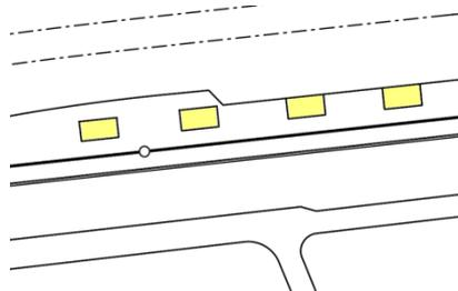
Humusierte Flächen mit einer verkehrsteilenden bzw. verkehrsleitenden Funktion (z.B. Trennung zwischen Fußgänger und Velo auf demselben Trottoir), sind als 'uebrige\_humusierte.Verkehrsteilerflaeche' zu erheben.
