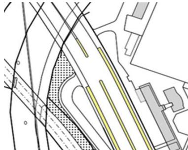
Vorwiegend humusierte Flächen, welche Verkehrsflächen für den Fussgänger- und/oder den Fahrzeugverkehr trennen, sind als 'uebrige\_humusierte.Verkehrsteilerflaeche' zu erheben.
