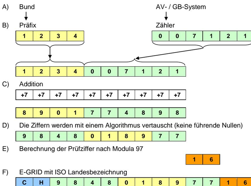
Abbildung 1: Aufbau und Erzeugung E-GRID
