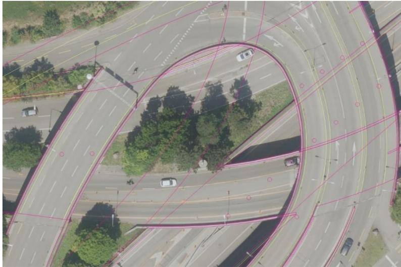
**Abbildung 8:** Auch Brücken auf verschiedenen Ebenen wurden aufwändig korrigiert, so dass sie geometrisch korrekt abgebildet sind. Zur Veranschaulichung der Lagegenauigkeit wurden dem Bild die Daten der amtlichen Vermessung überlagert.
