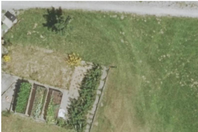
**Abbildung 9:** Ein Punkt auf der Bodenoberfläche (hier ein im Felde eingemessener Punkt), korrespondiert mit seiner Lage im Orthofoto bei 1-2 Pixel.
