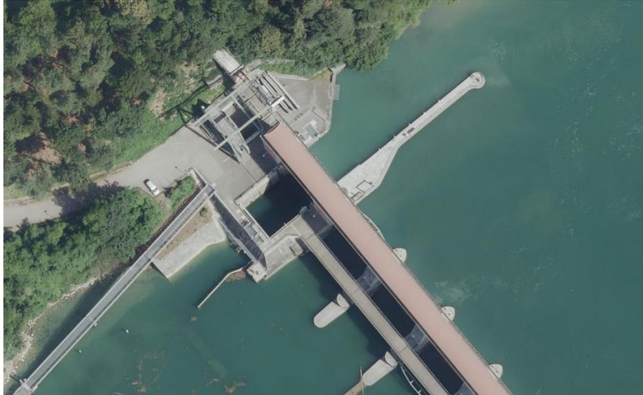
**Abbildung 11: Bei einem Kraftwerk gilt dieselbe Aussage wie bei einem Gebäude: Die Fahrbahn ist lagerichtig, obenliegende (Dächer) und untenliegende Teile (Pfeiler) werden nicht lagerichtig dargestellt**
